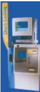
Geldautomat mit Iriserkennung © Visionics
