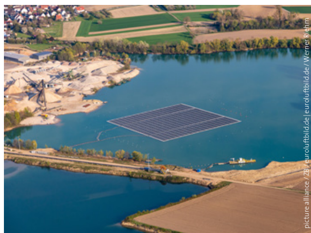
In Leimersheim, Rheinland-Pfalz, versorgen ein schwimmendes Solarkraftwerk und Panelfelder von Photovoltaik-Anlagen auf einem Baggersee das dort befindliche Kieswerk.
