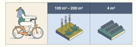
4m² Fotovoltaik-Freilandfläche produzieren im Durchschnitt genauso viel Energie wie eine unserer Fahrradfahrerinnen, also 1kWh pro Tag oder 365kWh im Jahr. Für Biomasse benötigen wir mindestens 100m² Ackerfläche mit Energiepflanzen, um nach einem Jahr genauso viel Energie in Form von Biomasse zu erhalten, also 365kWh.
