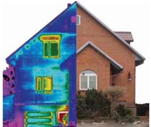
Aufnahme einer „Wärmebildkamera“ (linke Bildhälfte), die das infrarote Licht sichtbar macht. Hier sieht man, wie die Heizwärme durch die nicht gut wärmeisolierten Fenster eines Hauses nach außen dringt.
