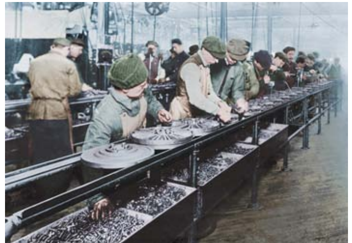
Der Manufacturing Belt von der Ostküste bis zum Mittleren Westen war das Zentrum der Industrieproduktion in den USA. Montage für das Ford Model T auf dem ersten Fließband weltweit 1911 im Werk Detroit
